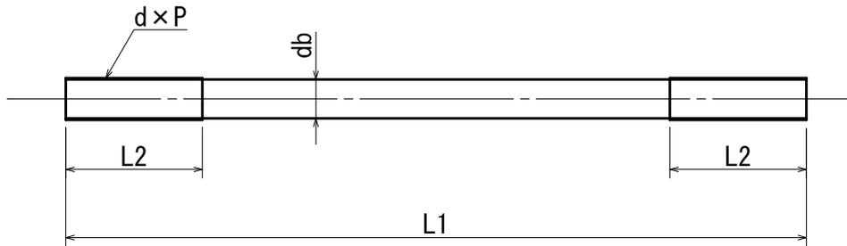
図2 アンカー用ボルトの形状
