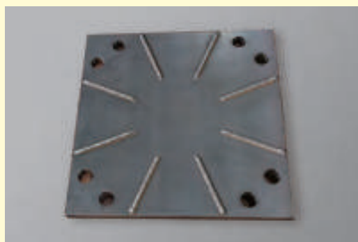
ベースプレート下面(BOP溶接)
